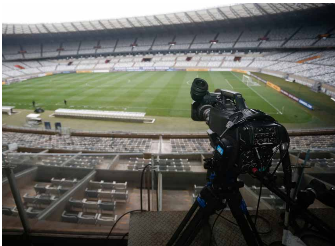
Cámaras fuera de Lugar (5 y 6): Dos cámaras instaladas exactamente en las líneas 18y, al mismo nivel o más alto que la plataforma de la cámara principal.
