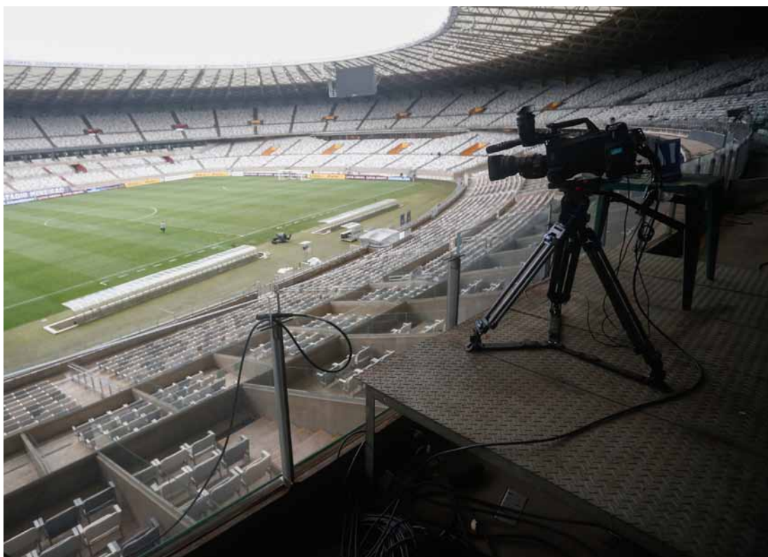
Cámaras fuera de Lugar (5 y 6): Dos cámaras instaladas exactamente en las líneas 18y, al mismo nivel o más alto que la plataforma de la cámara principal.
